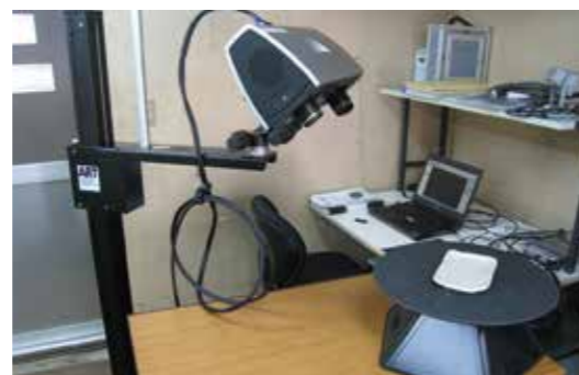
▲「COMET L3D」による3次元測定
