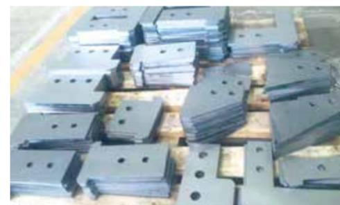
▲製缶部品レーザー切断
