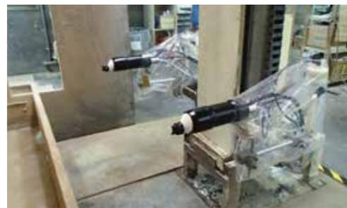
▲高電圧発生器内蔵方式静電ガン
