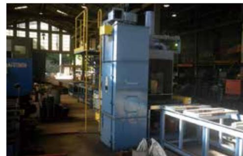
があった。特に、鉄表面の摩擦面処理において品質安定化および作業負担の軽減が喫緊の課題となっていた。平成25年度の補助事業では、この点を改善することにより納期面・コスト面において大都市部の新規市場で勝負できるようになると見込み、表面研削を行うショットブラスト装置を導入した。
