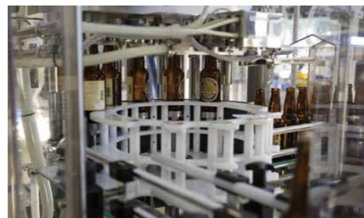
▲一瞬で瓶内を2度真空状態にする
