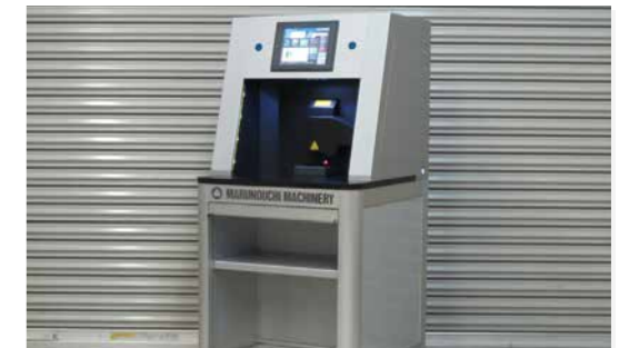
▲完成した面取り測定装置
